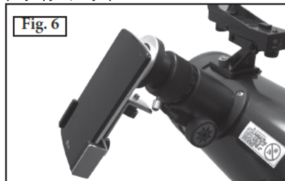
Вставьте 20мм окуляр Окуляр без резинового наглазника 4. Вставьте окуляр вместе с держателем телефона в фокусирующее устройство телескопа, как показано на Рис.6, и закрепите окуляр при помощи барашковых винтов фокусирующего устройства.
